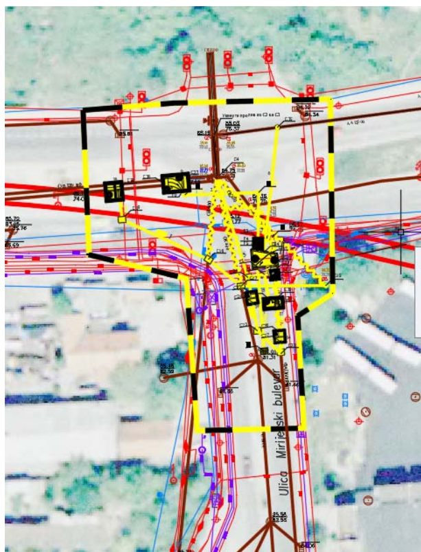
Слика 2-2 Приказ новопројектованих објеката за прикључак отпадних вода на Интерцептор – Деоница 8
